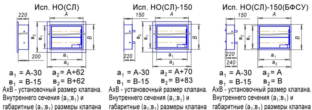
Рис.1. Установочные, габаритные и размеры внутреннего сечения клапана.
